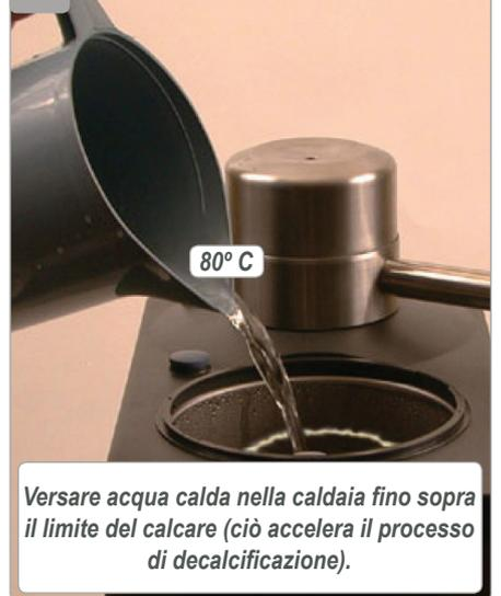
Versare acqua calda nella caldaia fino sopra il limite del calcare (ciò accelera il processo di decalcificazione).
